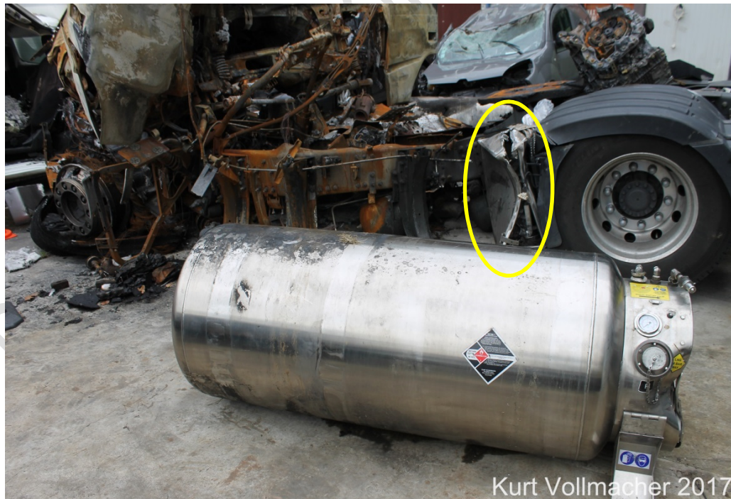
Figuur: handbediende afsluiters waren niet bereikbaar
