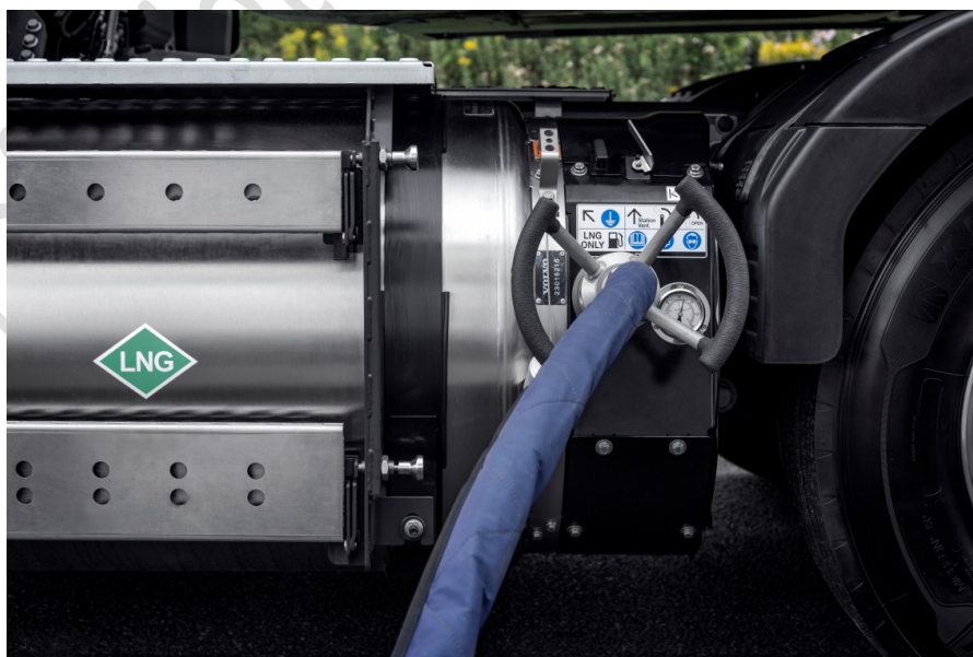
Figuur: Nieuwe Euro 6 LNG tank Bron Volvo
