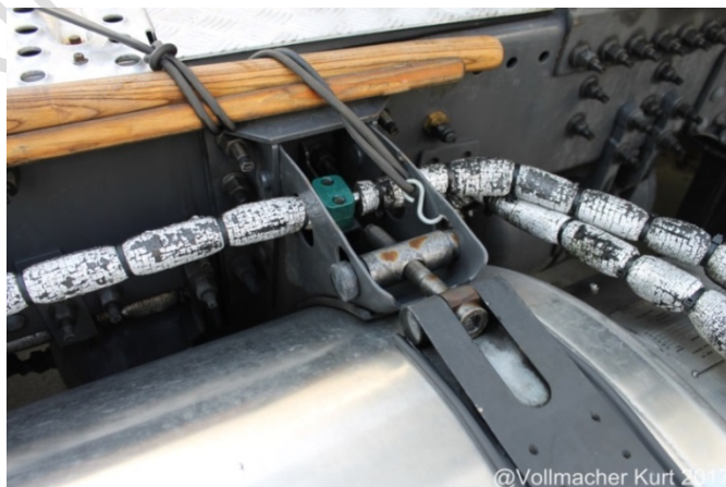
Figuur: detail een van de spanbanden van de LNG tank
