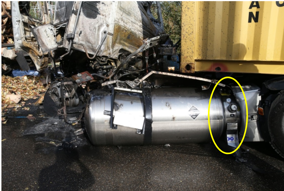
Figuur: kranen/aansluitingen en 'vent' aflaatpunt niet bereikbaar BFM Foto BFM
