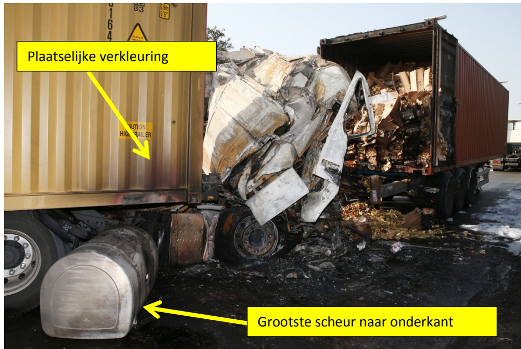
Figuur: aanstraling door uitgestroomde brandstof. Foto
