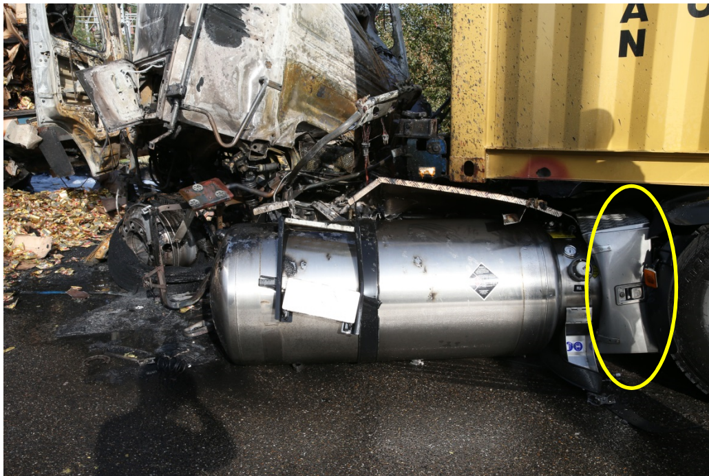
Figuur: handbediende afsluiters waren niet bereikbaar. Foto BMF
