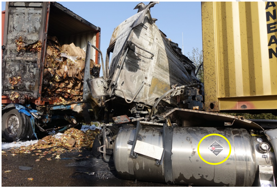
Figuur: volledig intacte aanduiding op de tank. Foto BMF
