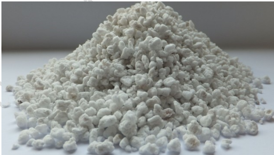
Figuur: Perliet die gebruikt wordt als isolatie tussen de mantels van de tank Bron SIBLI
