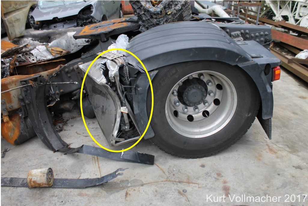
Figuur: handbediende afsluiters waren niet bereikbaar
