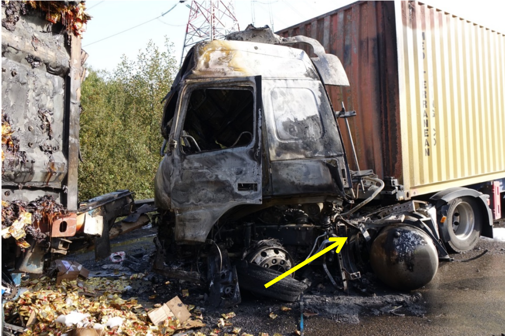
Figuur: tank hangt nog vast aan 1 spanband en achterste plaat Foto BFM
