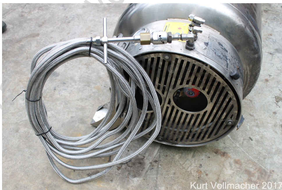
Figuur: cryogene slang voor aflaten van de druk in de tank.
