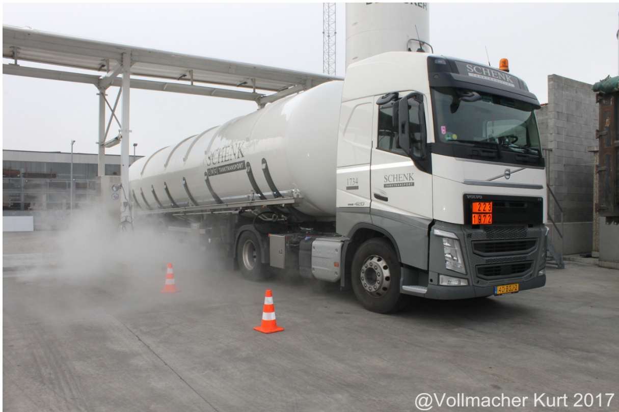
Figuur: condens bij het lossen van LNG : geen LNG lek!
